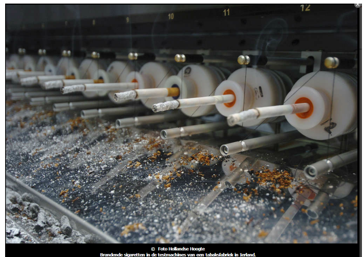
© Foto Hollandse Hoopje Brandende sigaretten in de testmachines van een tabaksfabriek in Ierland.
